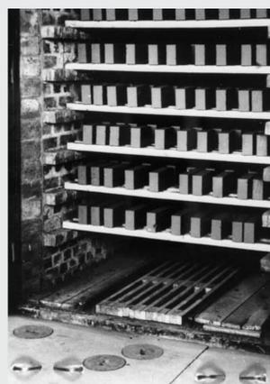
»Ziegelwerk Neuengamme. Blick in eine voll besetzte Trockenkammer. Hier ist die Beladung der Etagenwagen automatisch abgesetzt. Hamburg, den 15.7.47. O. Goerges«. Aufnahme ca. 1943. Foto: unbekannt. (NARA, M 890, Roll 27, Affidavit Goerges, Bild 7)
