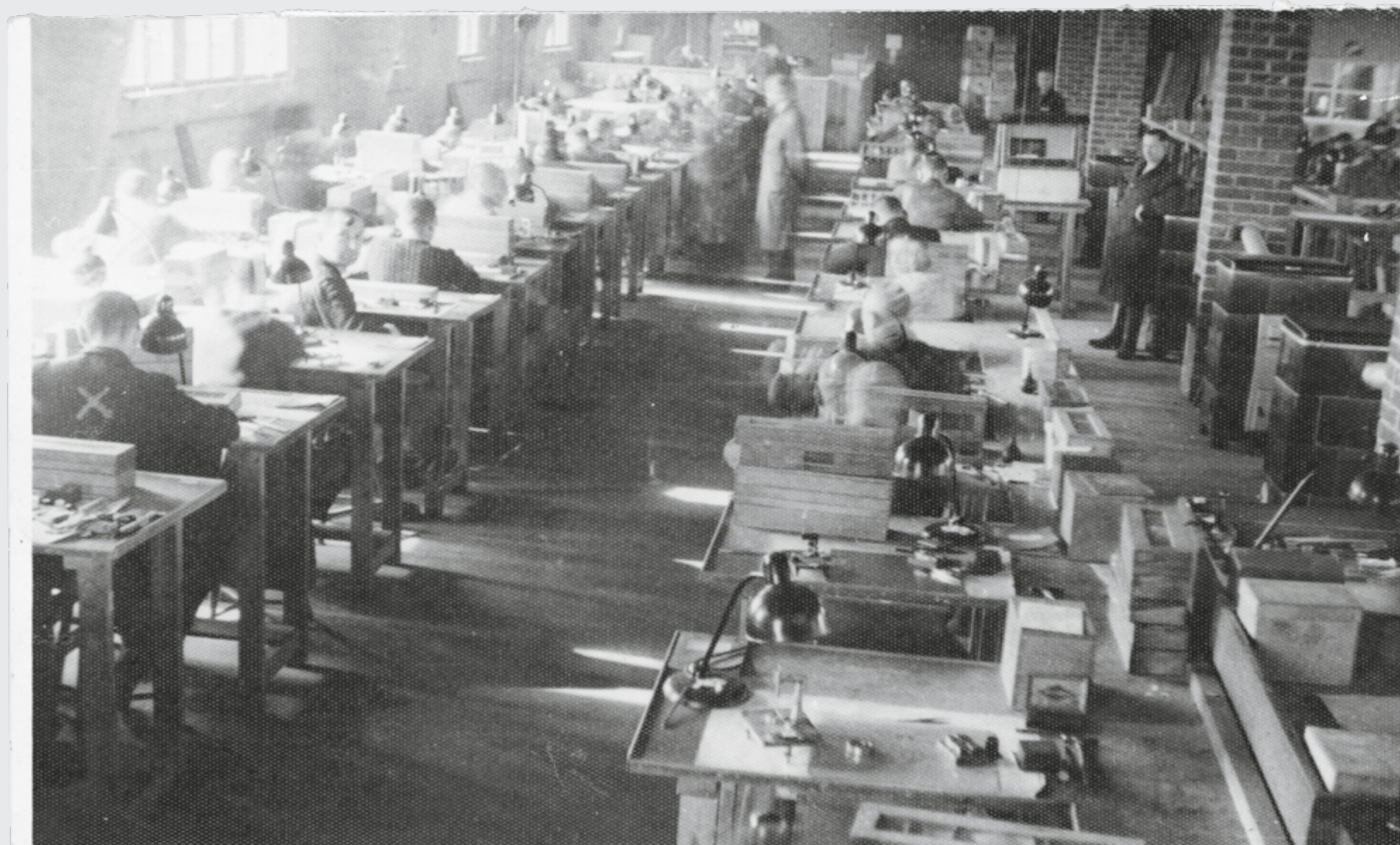
Die Präzisionsarbeit bei der Montage komplizierter mechanischer Zeitzünder musste mit Pinzette unter der Lupe ausgeführt werden. Aufnahme aus der Messap-Werkhalle, vermutlich 1944. Foto: vermutlich Karl Starkjohann, 7,9 cm × 13,5 cm. (ANg, 1983-2776b)
